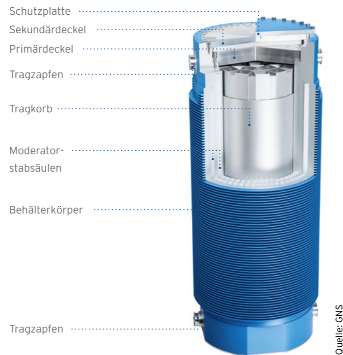
Abbildung 4: CASTOR®-Behälter in Lagerkonfiguration (Beispiel CASTOR® V/19)
