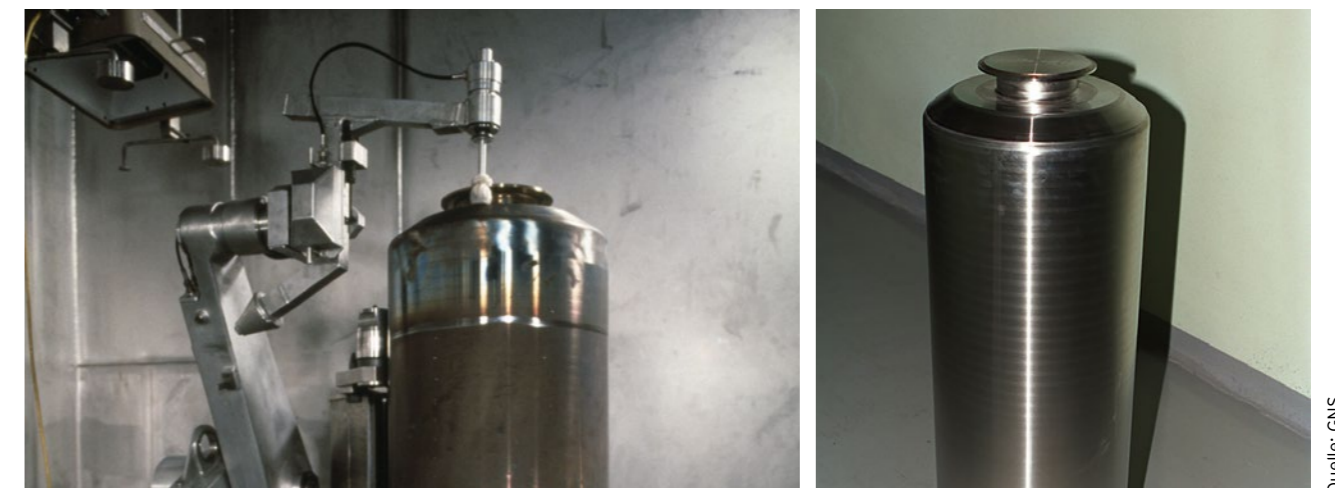
Abbildung 14: Beladung eines Behälters mit HAW-Glaskokillen (links), einzelne Kokille (rechts)
