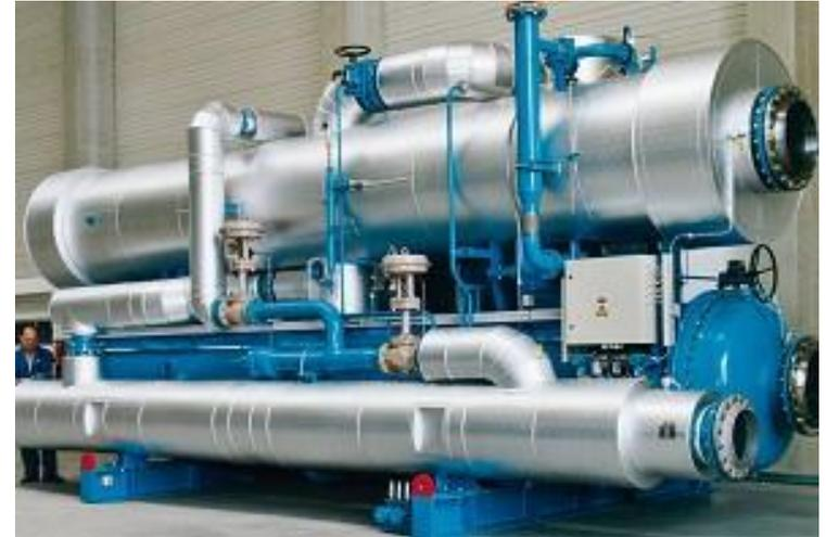
Meerwasser-Wärmepumpe Fernwärmeversorgung Stockholm-Värtan
